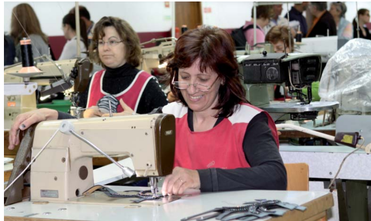
Seit 25 Jahren produziert Ströber im eigenen Werk in Portugal. Der Trend zur Verlagerung der Produktion nach Asien stand bei Ströber nie zur Debatte. Die aktuellen Tagesproduktionen von 450 Paar laufen bewusst halbautomatisch. Viele der insgesamt 150 Arbeitsschritte werden noch in Handarbeit ausgeführt
